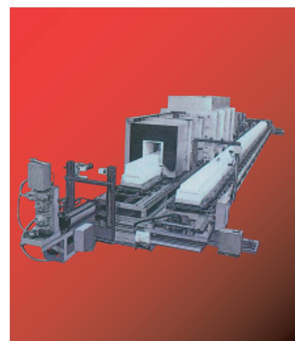
本炉は全自動台車式にて、大気霧囲気中におけるセラミック等の焼成にご利用いただけます。
