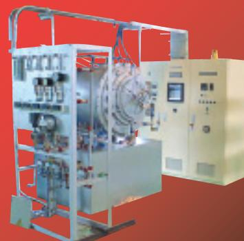
本炉は遮熱に金属板方式を採用し、急速昇降温が可能な還元雰囲気中におけるセラミック等の多目的焼成をご利用いただけます。
